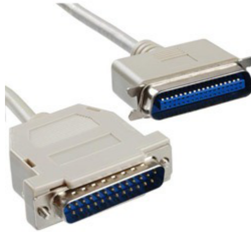
Figura 5 - Exemplo de cabo de impressora com conectores DB25
