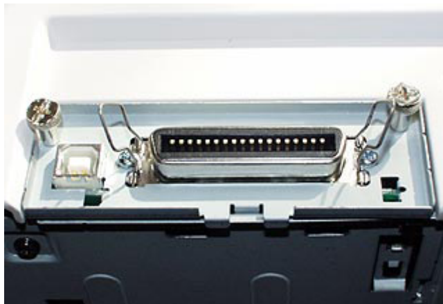
Figura 6 - Interfaces USB e DB25 de uma impressora.
