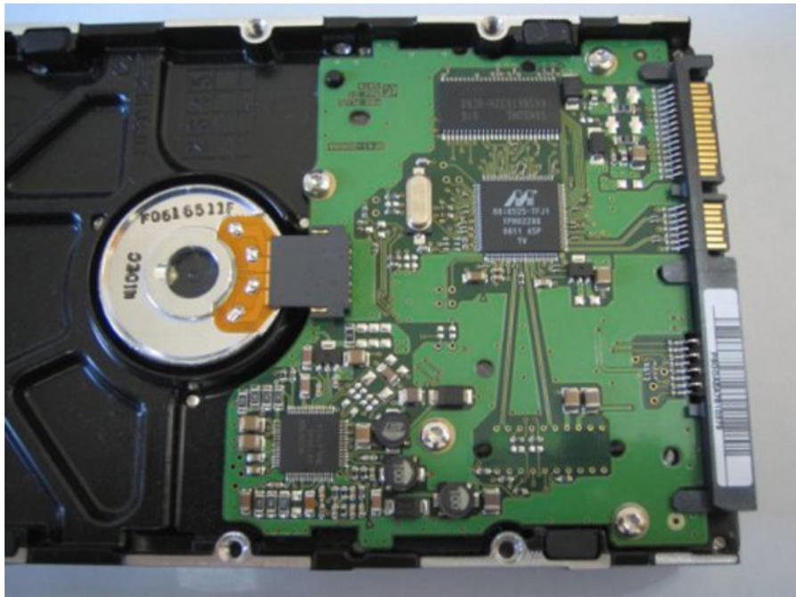
Figura 5 - Placa Controladora de um HD
