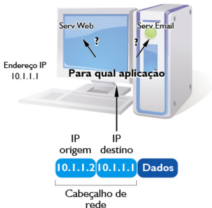
Para resolver esse problema, a camada de transporte oferece um mecanismo de identificação das aplicações chamado de *porta*. Uma porta nada mais é que um número (de dois bytes) que identifica cada aplicação. Na verdade, a porta identifica um “canal de comunicação” dentro da aplicação, uma vez que uma mesma aplicação pode utilizar várias portas.
