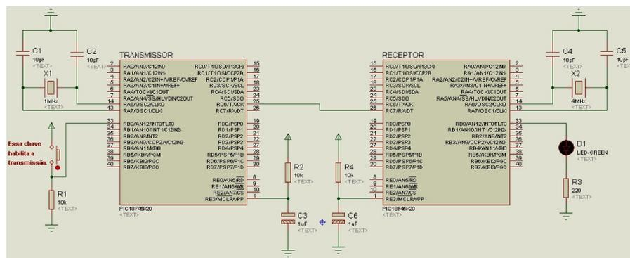
Figura 1 - Esquemático completo do sistema com o transmissor e o receptor
