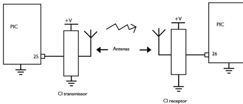
**Figura 6** - Esquema da ligação dos CIs transmissor e receptor.
