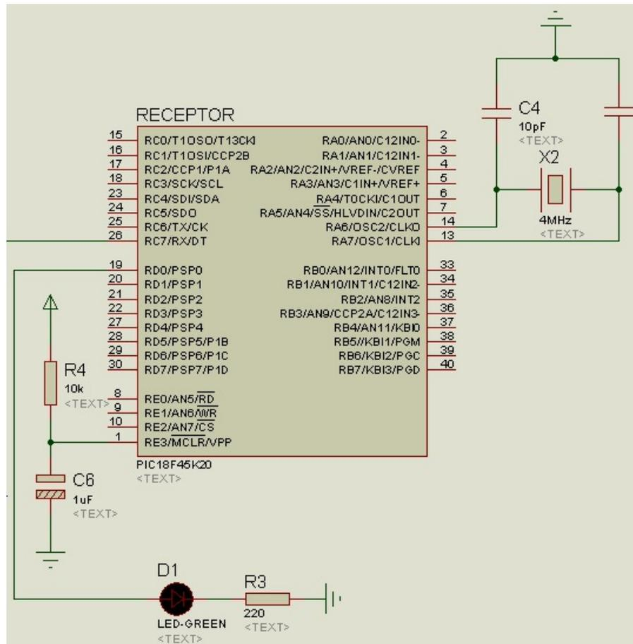
Figura 4 - Novo esquema do circuito de recepção.
