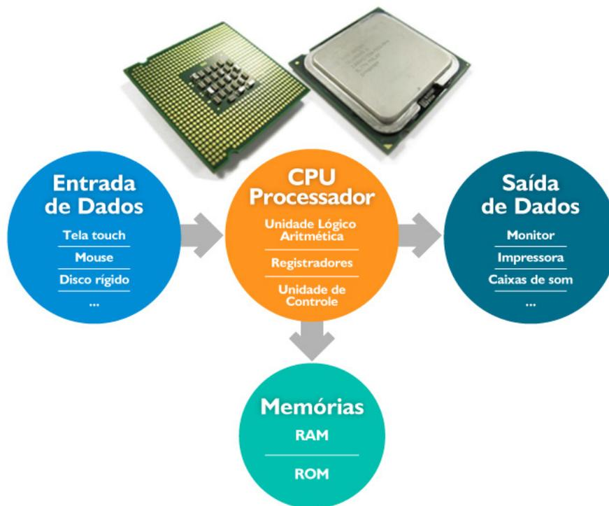
**Figura 1** - Representação de um microprocessador típico
