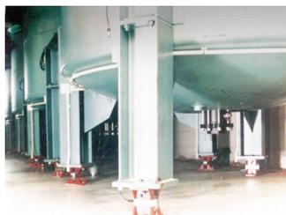
**Figura 2** – Exemplos de medição de nível por pesagem.
