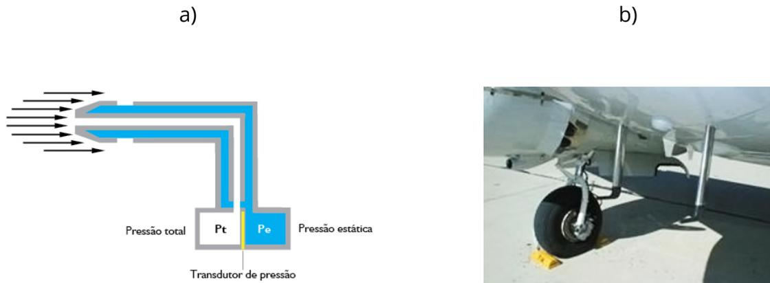
**Figura 13** – (a) Esquema de um tubo de Pitot; (b) Fotografia de um tubo de Pitot em uma aeronave.
