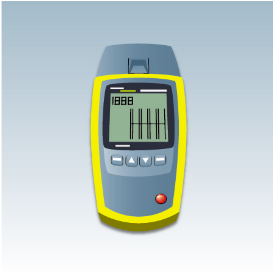
Figura 02 - Fluke Microscanner: melhor do que os testadores de cabos, mas incapaz de certificar uma instalação de cabeamento.
