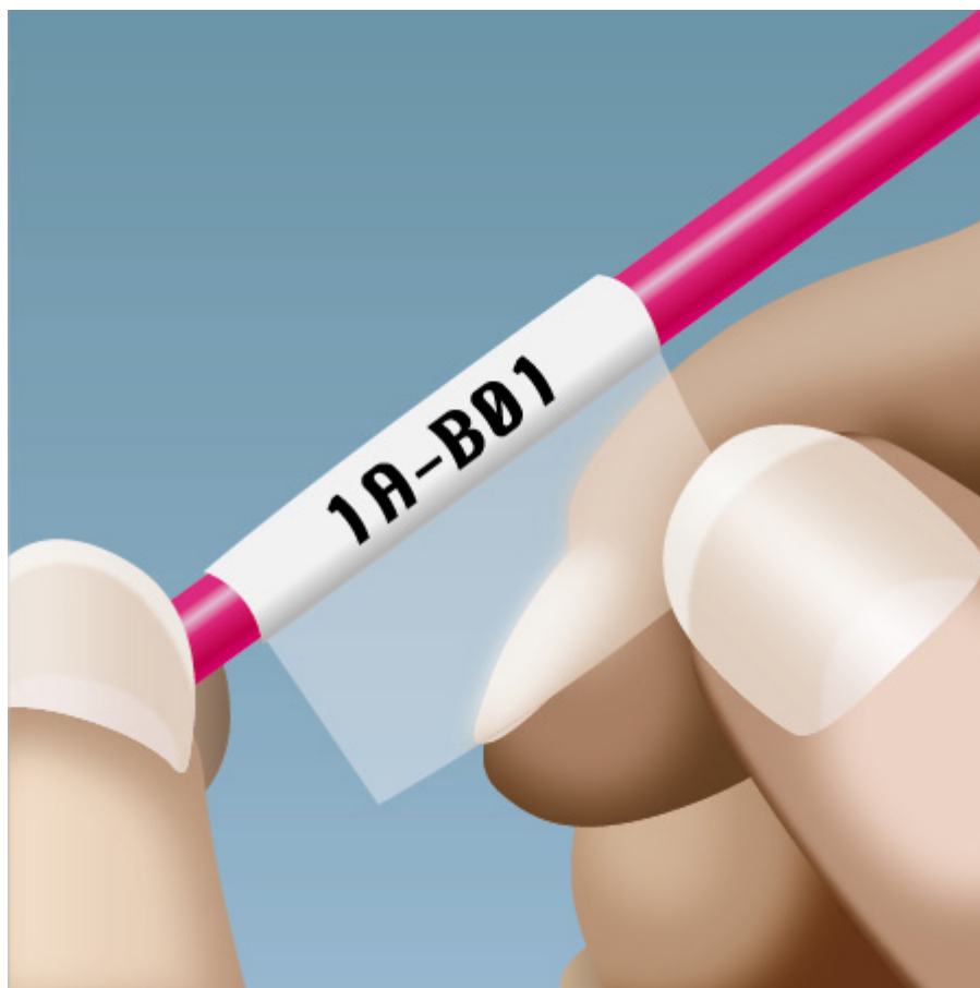
Figura 04 - Aplicação das etiquetas no cabo.
