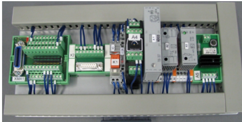
Figura 12 - Placa de conexões e conversões da planta didática
