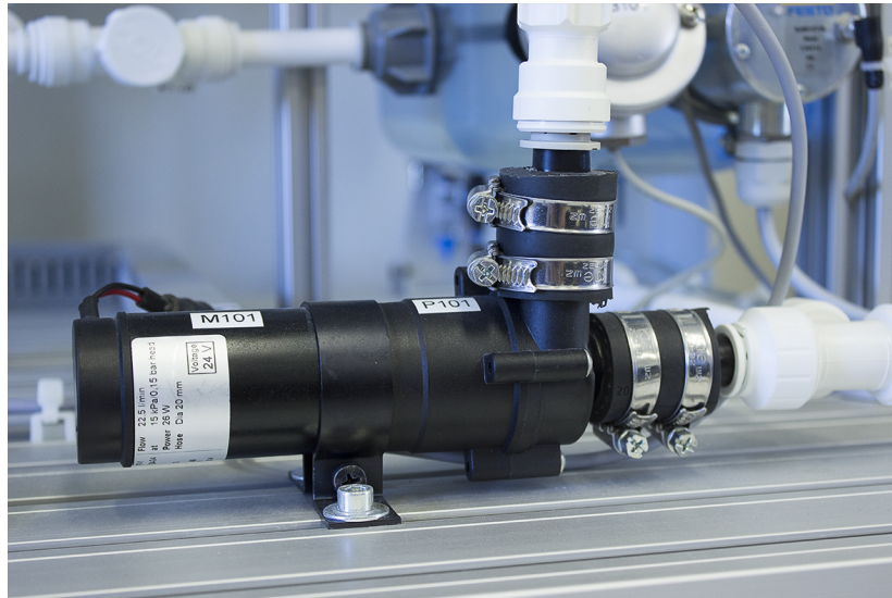
Figura 10 - Bomba responsável pelo bombeamento do líquido pela tubulação.
