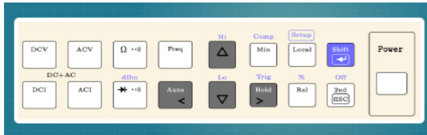
Figura 10 - Desenho representativo do painel de teclas do multímetro U3401A.
