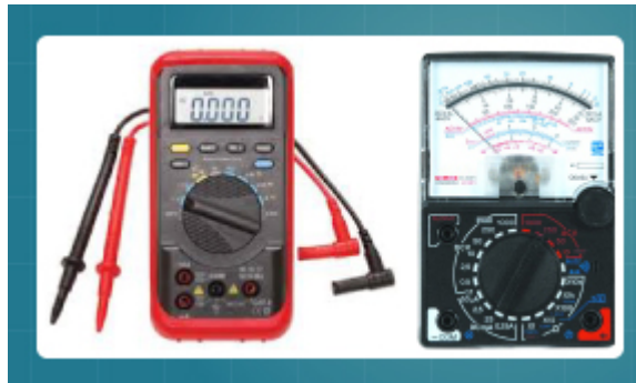
Figura 01 - Multímetro portátil digital (à esquerda) e multímetro portátil analógico (à direita).
