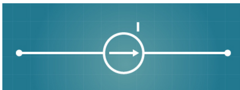
Figura 07 - Fonte de corrente contínua.
