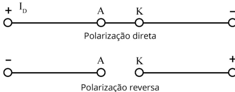
Este comportamento descreve a característica de um diodo ideal, ou seja, basta que a tensão seja positiva para que o mesmo entre em condução e, em caso de corte, a corrente que flui pelo mesmo é zero. A figura 7, a seguir, ilustra o comportamento da tensão e corrente nas duas polarizações.
