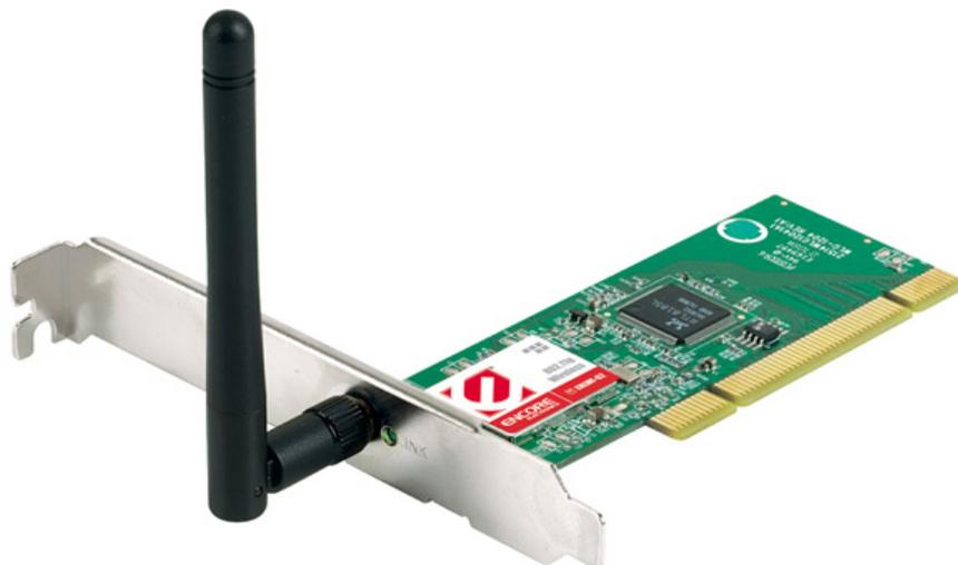
**Figura 6** - Placa de rede sem fio
