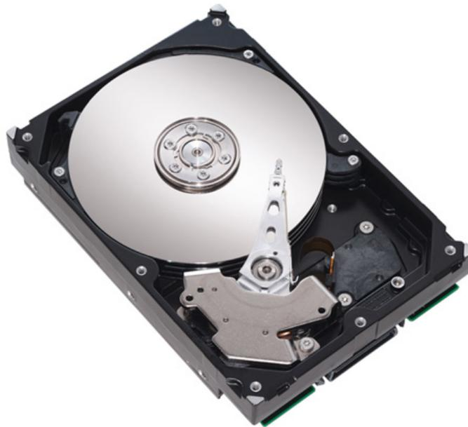
**Figura 3** - Visão interna de um HD
