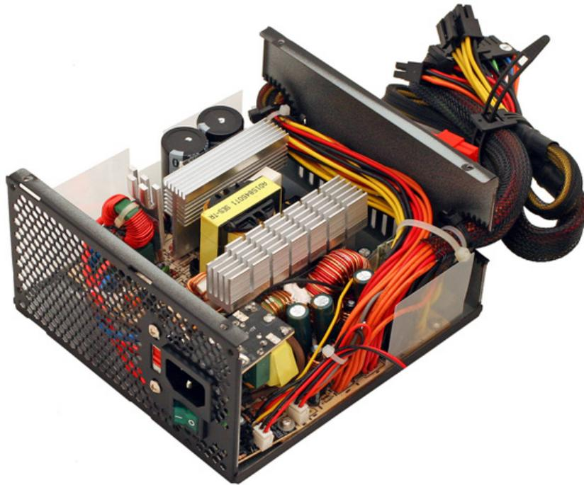
**Figura 11** - Fonte de alimentação ATX
