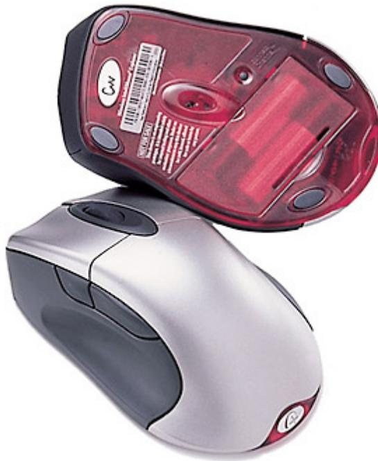
**Figura 19** - Mouse infravermelho.
