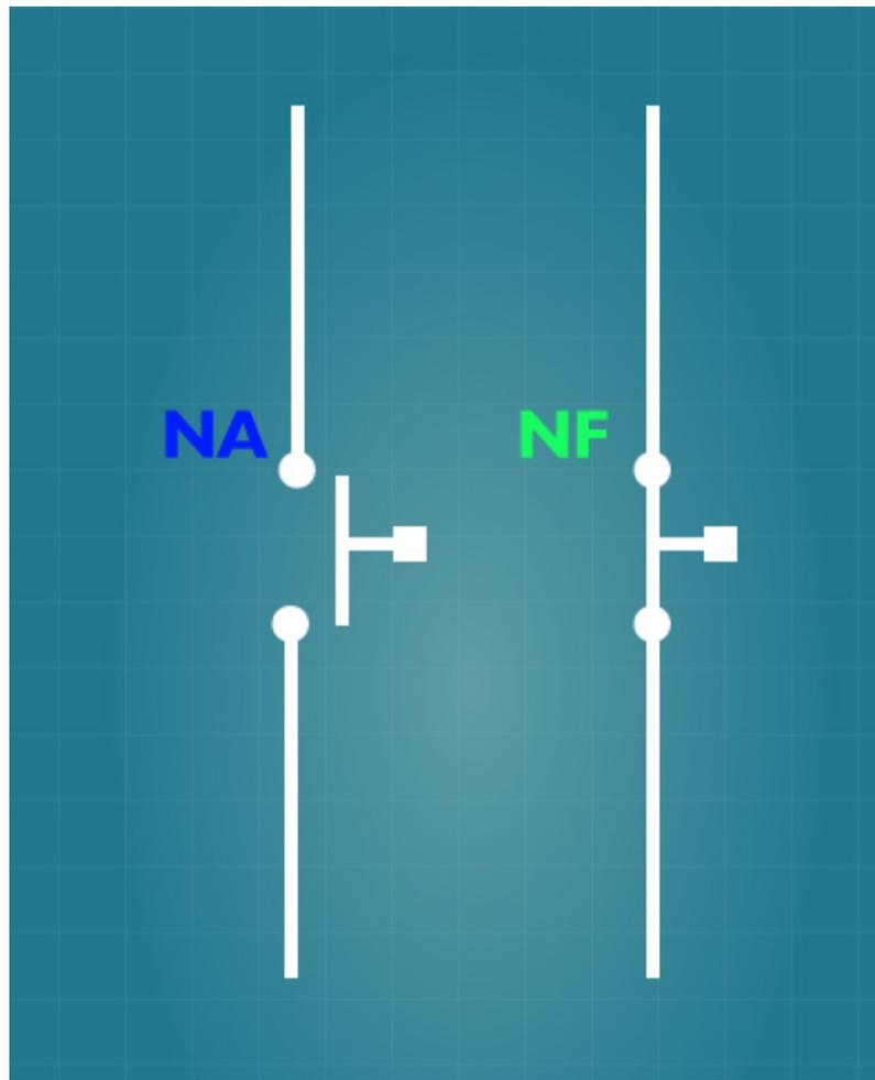
**Figura 6** - Diagrama de botoeira com contato. Normalmente Aberto (NA) e Normalmente Fechado (NF).
